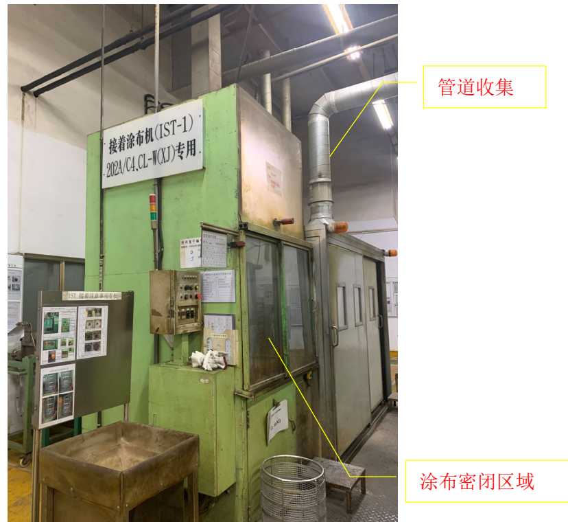
图8-2 涂布废气收集示意图
