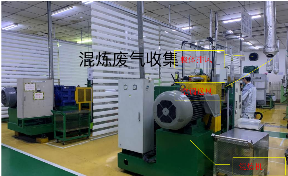
图8-3 混炼室废气收集示意图
