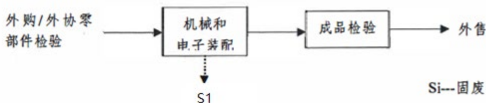
图 2-4 3D 打印设备生产工艺流程图
