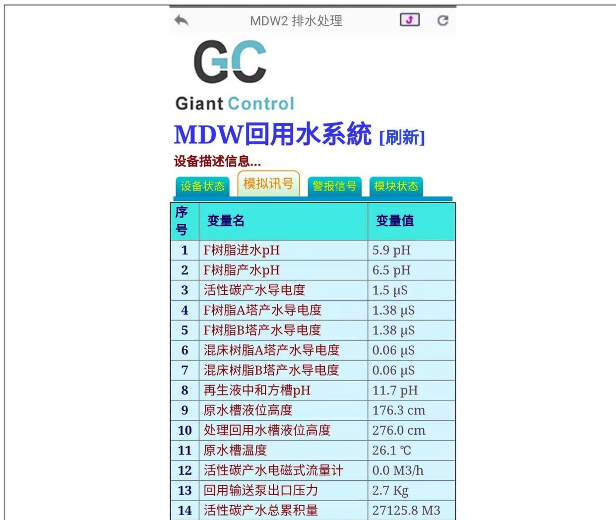
图 7-1 生产废水处理设施实时监控信息
