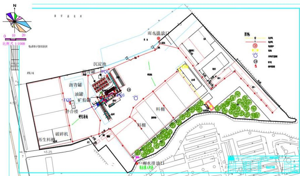
图3.2-6 锡通路桥平面布置与雨污水管网图
