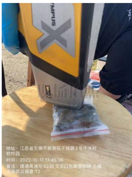
图 4.2-1 现场快速筛查照片 (XRF)
