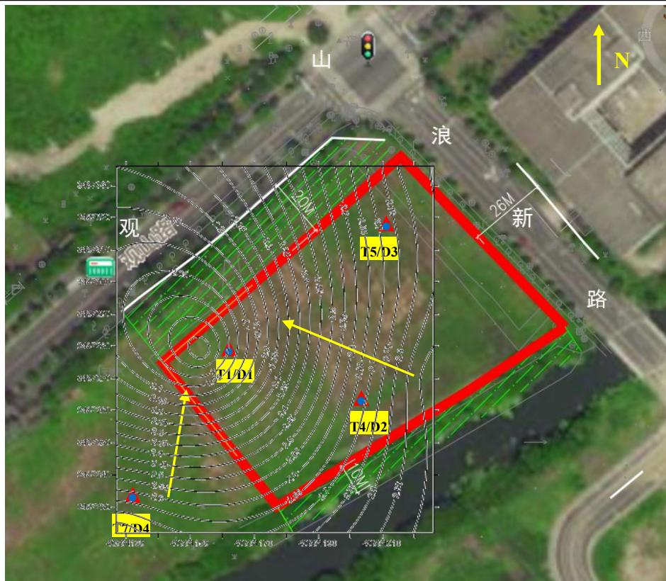
图 2.3-3 地块内地下水位流向图
