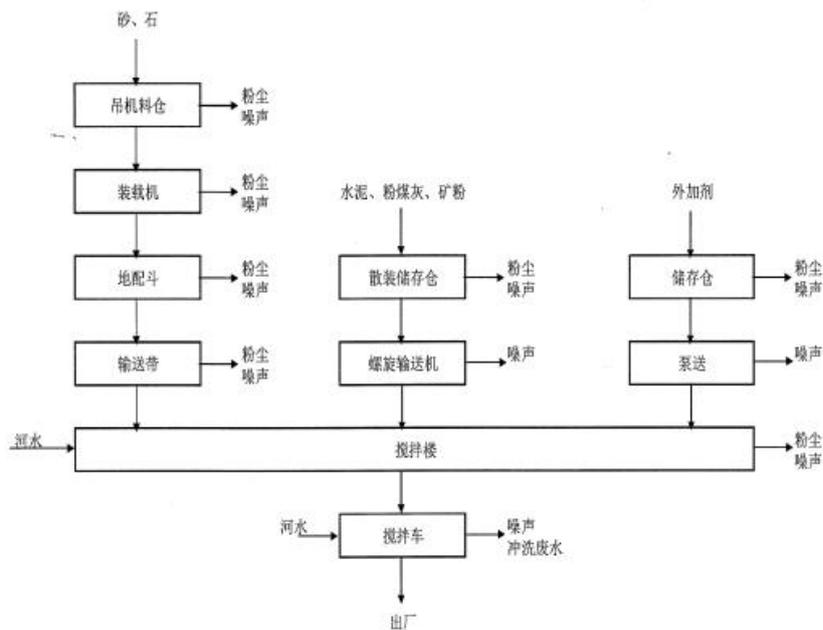
图 3.2-1 混凝土生产工艺流程图
