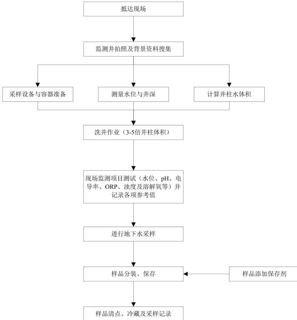
图 4.1-5 地下水采样流程图
