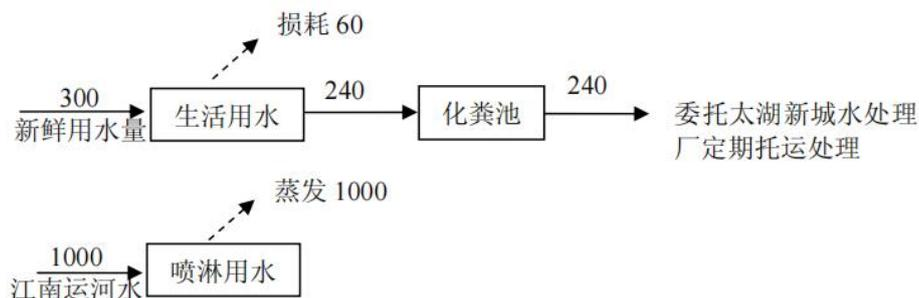
图3.2-5 项目水汽平衡图（单位：t/a）
