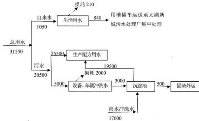
图3.2-2 项目水汽平衡图（单位：t/a）
