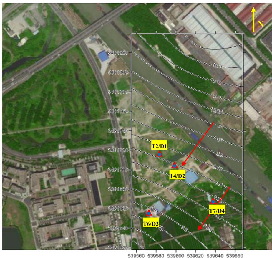
图 2.3-3 地块内地下水位流向图
