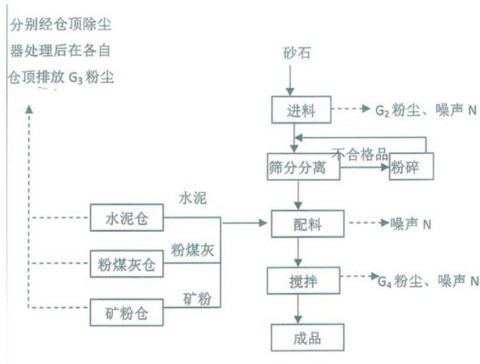
图 3.2-7 混凝土生产工艺流程图
