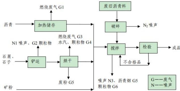
图 3.2-4 沥青生产工艺流程图
