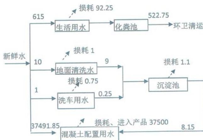
图3.2-8 项目水汽平衡图 (单位: t/a)
