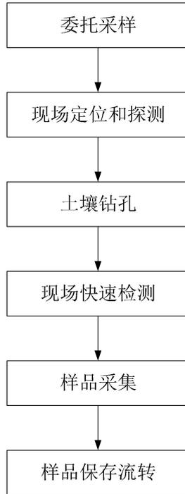
图 4.1-4 土壤采样流程图
