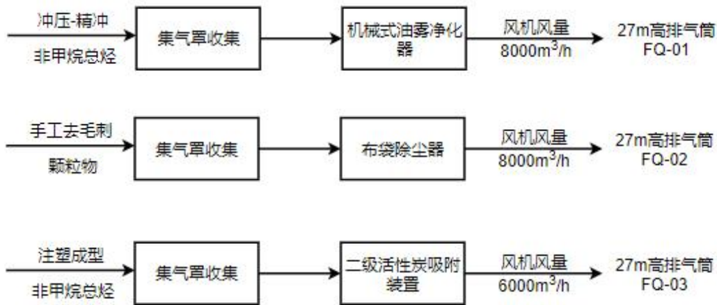
图 4-1 本项目废气污染治理方案示意图
